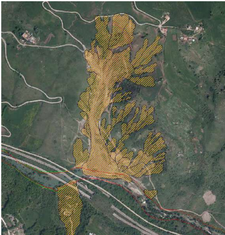
Fiume Basento: Tricarico. Il cumulo di frana ha ostruito l'alveo del fiume a valle del ponte ferroviario e dei viadotti della S.S. 407 Basentana
