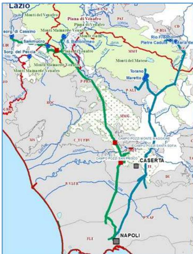
Fig.28 Schema idrico Acquedotto Campano
