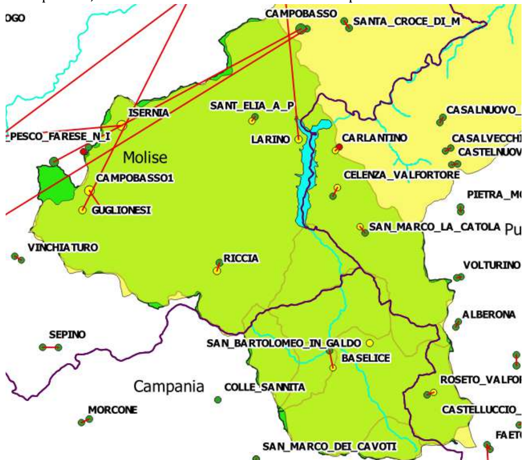
Figura 11 – Collegamento (in rosso) fra gli agglomerati (in giallo) e i depuratori (in verde) presenti nel bacino totale della diga di Occhito.
