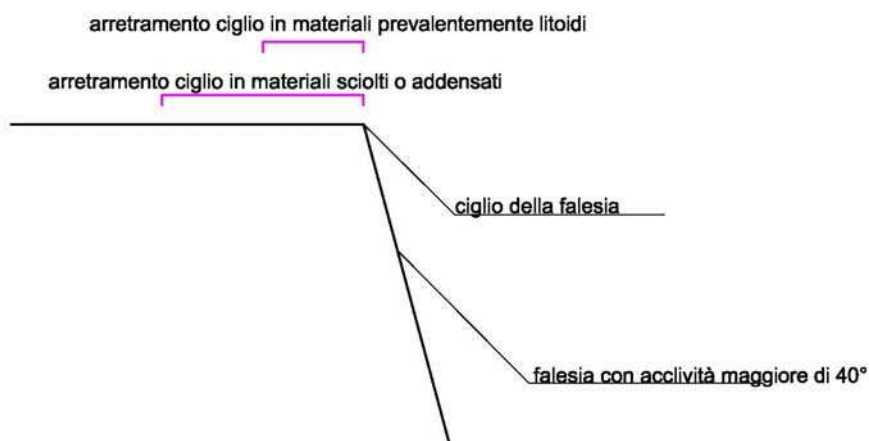
Figura 7: Schema esemplificativo adottato per l'analisi dell'arretramento del ciglio delle falesie.
