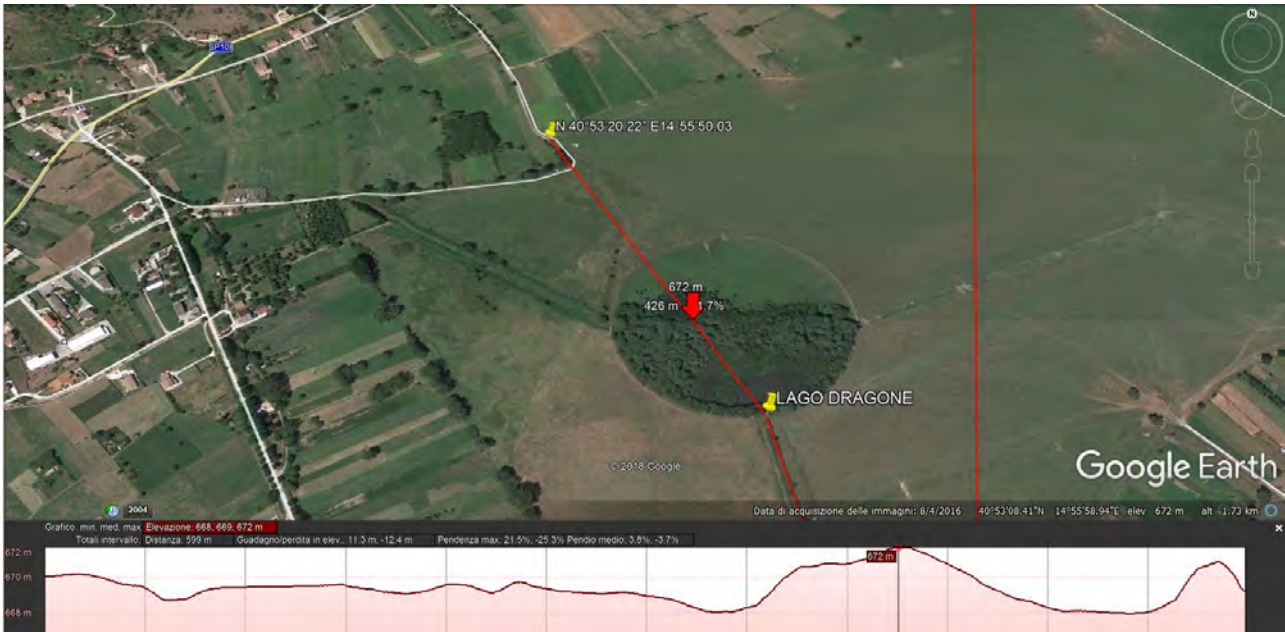
Fig.21: Ipotesi rilancio wireless del segnale del sito “Canale Coperto”
