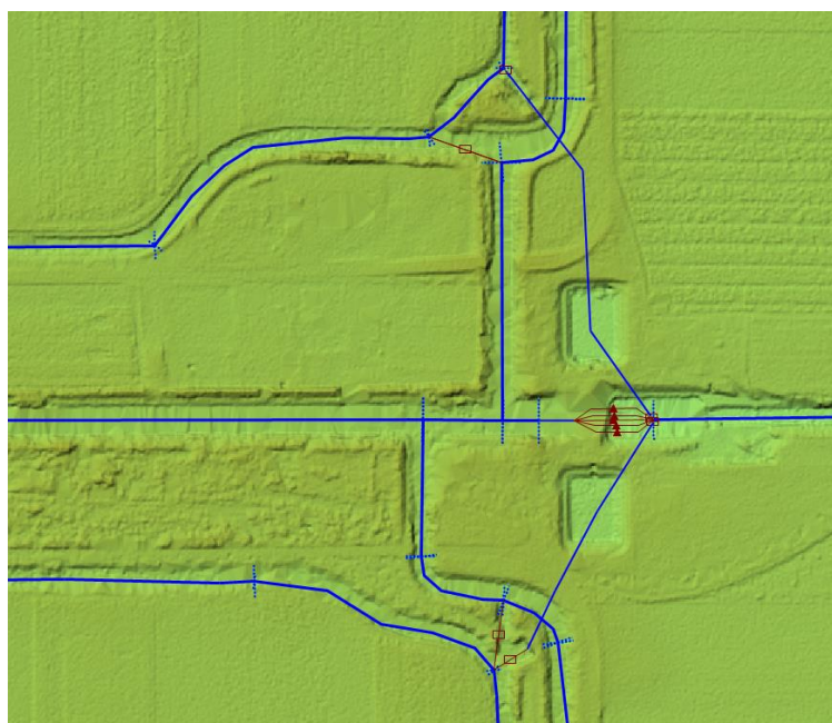
Figura 2.2: Visualizzazione in InfoWorks del DTM con risoluzione 0,25 m ricavato dal rilievo Lidar della zona di Borgo Ottomila, è possibile osservare il reticolo dei canali e alcune opere speciali come vasche e idrovore.
